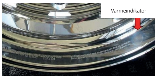
Bild 13-2 Värmeindikator vid fälgfläns
