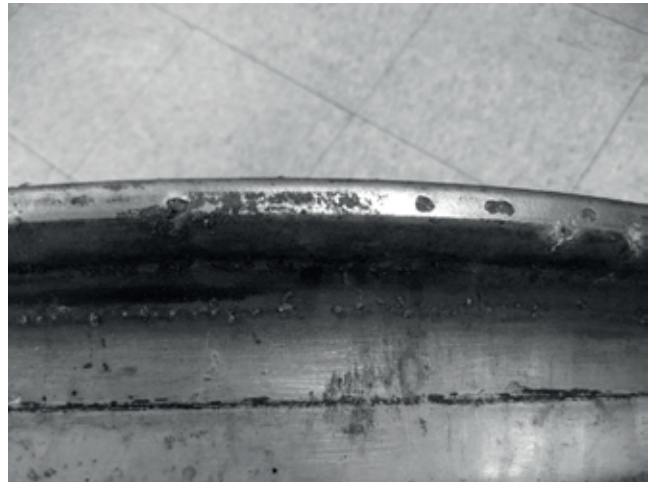
Bild 13-37 Acceptabelt slitage och gropbildning
