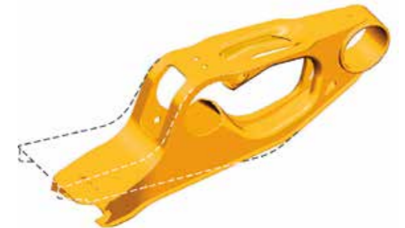
Asymmetrisch konstruiert: Der Balgversatz sichert die Wahlfreiheit bei der Bereifung
