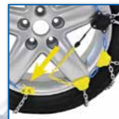
Spannkette einlegen Insérer la chaîne de serrage Inserire la catena di serraggio
